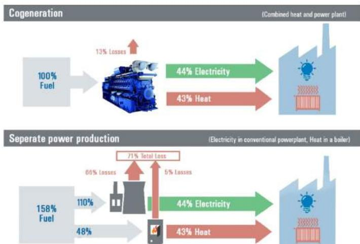
**Figure 10.6.** Cogeneración comparada con la producción de energía separada (Fuente: www.mwm.net).
