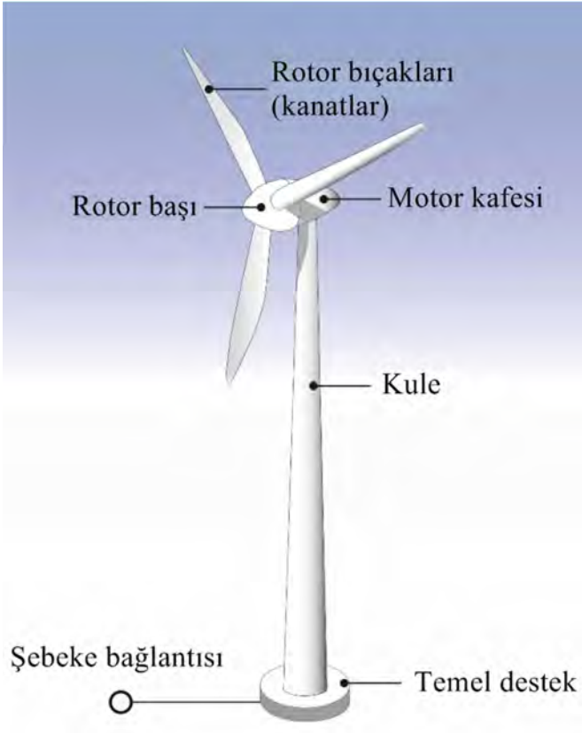
Şekil 6.1. Rüzgar enerji türbini bileşenleri (RENAC, 2017)
