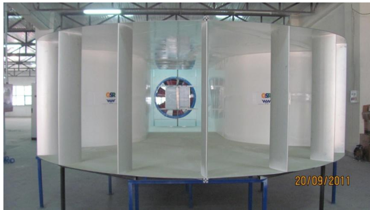
Şekil 11 GSRRT Tünelinin görünümü
